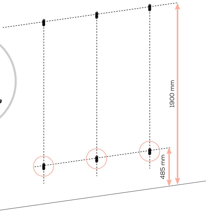
\* Fixation dans le mur: Le choix des types de vis et cheville, ainsi que de la méthode de perçage pour les fixations murales sont fonction de la nature et de la qualité du mur (cloisons tendres / cloisons dures) et, de ce fait, relèvent de votre responsabilité. Achetez-les chez un spécialiste.
