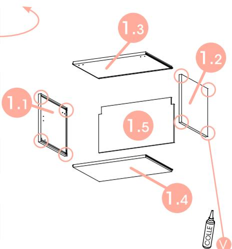
Un point de colle en fond de rainure et à toutes les extrémités doit être appliqué avant l'assemblage.
