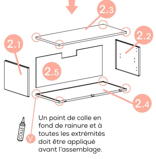
Un point de colle en fond de rainure et à toutes les extrémités doit être appliqué avant l'assemblage.
