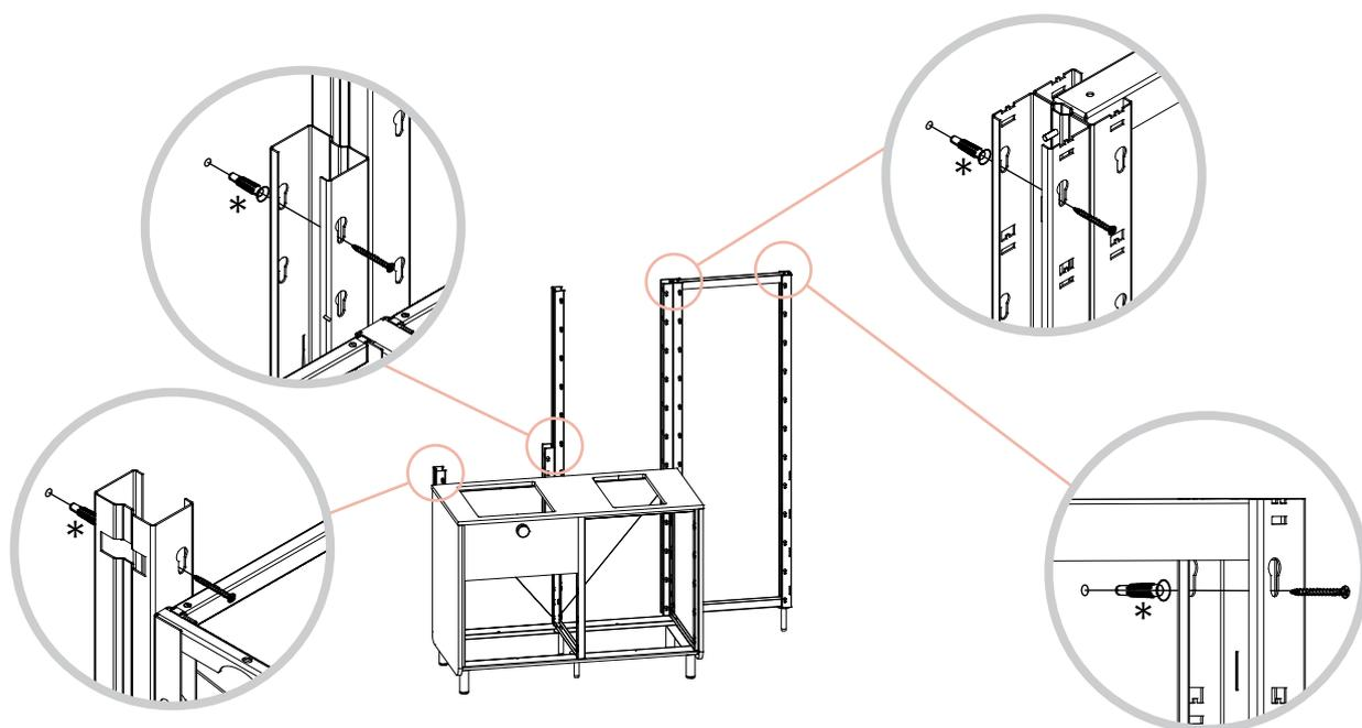
\* Fixation dans le mur : Le choix des types de vis et chevilles, ainsi que de la méthode de perçage pour les fixations murales sont en fonction de la nature et de la qualité du mur (cloisons tendres / cloisons dures) et de ce fait, relèvent de votre responsabilité. Achetez-les chez un spécialiste.
